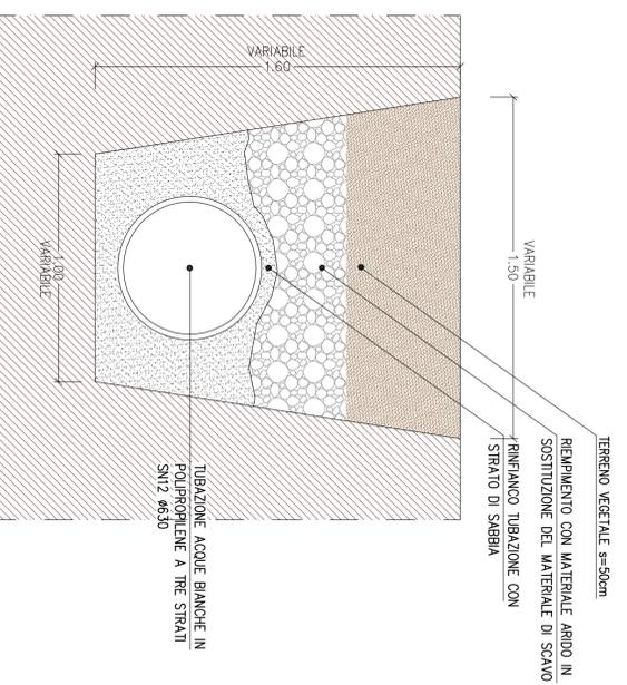
**PARTICOLARE SEZIONE TIPO DI SCAVO
